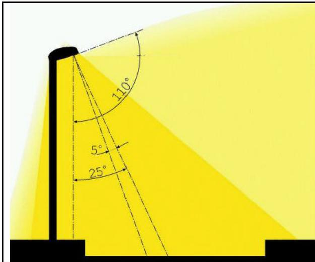
Figura 5.28 Apparecchi con fasci poco inclinati vengono inclinati per aumentare l'uniformità trasversale. Installazione non corretta per la LR17/00 con luce inviata verso il cielo (fonte Cielobuio)
