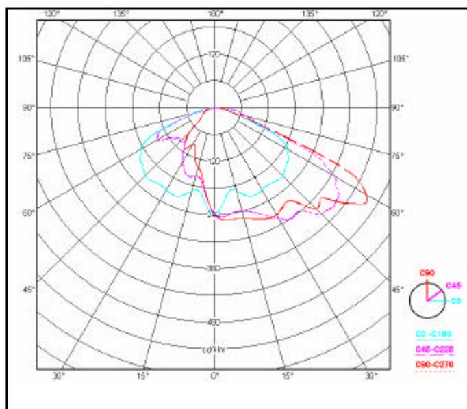
Figura 5.22 – Curva fotometrica di apparecchio asimmetrico misurata su 3 piani.
