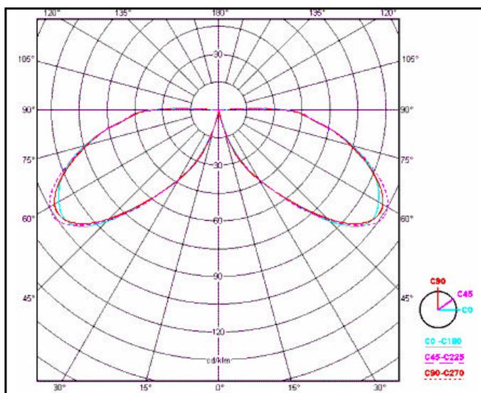
Figura 5.20 – Curva fotometrica simmetrica (le misure su i tre piani sono quasi identiche)
