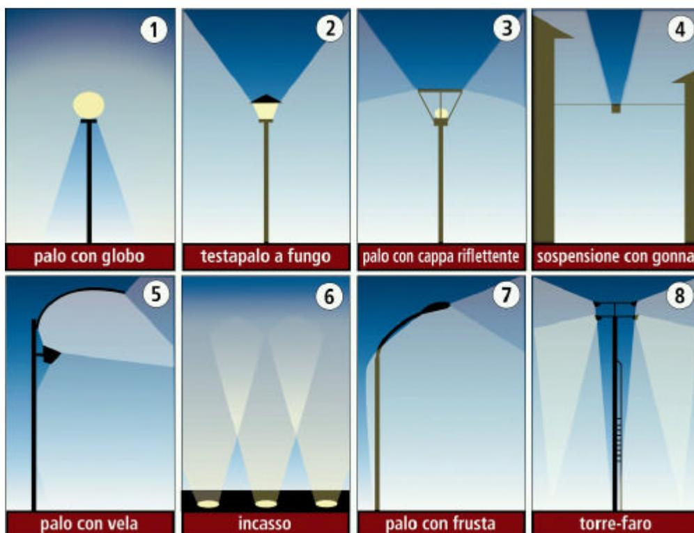
Figura 5.9 – Apparecchi non conformi con la LR17/00. Alcune di queste tipologie presenti anche sul territorio comunale possono facilmente essere adattate anche mediante l’inserimento di alette schermanti. Purtroppo altre possono solo essere sostituite. (fonte Cielobuio)
