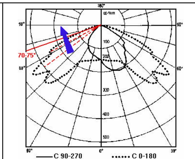
Figura 5.25 – Curva di apparecchio che allarga molto il fascio longitudinalmente alla strada (tratteggiata) e con buona asimmetria ed emissione della luce verso l'estremità opposta della strada (curva piena)
