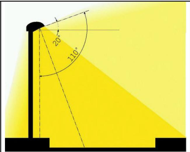
Figura 5.20 Apparecchi orizzontali con vetro inclinato per inclinare il fascio luminoso e migliorare le prestazioni trasversali. Installazione non corretta per la LR17/00 (fonte Cielobuio)
