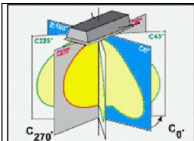
Figura 5.3 – Intensità luminosa tracciata in ciascun piano che taglia il corpo illuminante. La somma di tutte le intensità luminose a 360° su tutti i piani rappresenta il "solido" fotometrico dell'apparecchio. (fonte Cielobuio)
