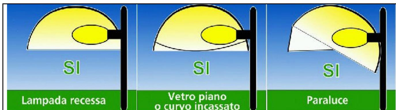
Figura 5.2 – Tipologie di apparecchi illuminanti conformi alla L.R. 17/00 (fonte Cielobuio)
