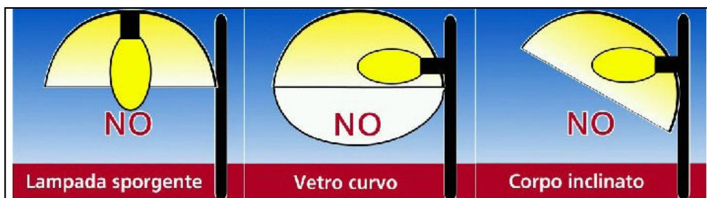
Figura 5.1 – Tipologie di apparecchi illuminanti non ammessi (fonte Cielobuio)
