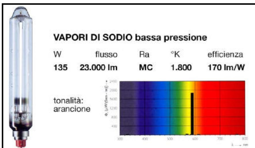
Figura 5.15 – Caratteristiche principali di alcune tipologie di Lampade al sodio bassa pressione
