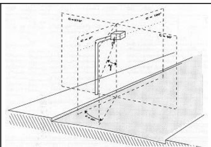
Figura 5.4 – Schematizzazione di come viene rappresentata l'intensità luminosa. Esiste una intensità luminosa per ogni angolo Gamma su ogni piano C. (fonte Cielobuio)
