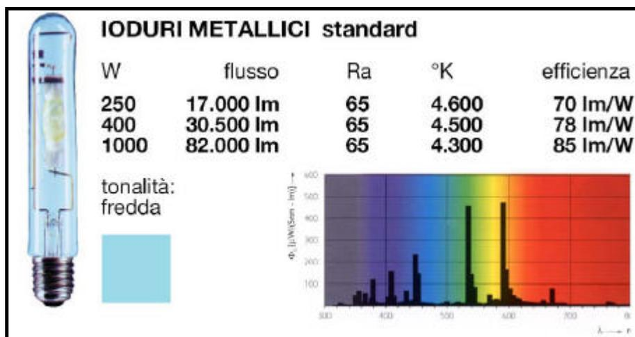
Figura 5.17 – Caratteristiche principali di alcune tipologie di Lampade agli ioduri metallici
