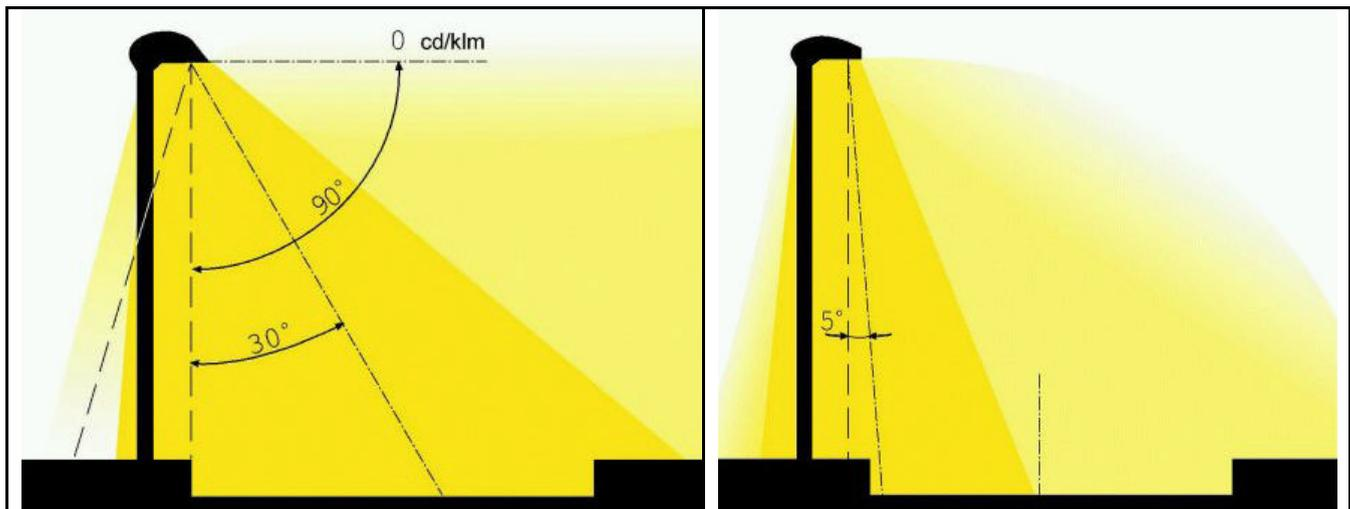
Figura 5.26 – Apparecchio che illumina adeguatamente tutta la carreggiata lungo la direzione trasversale con fascio inclinato di 25°-30° (fonte Cielobuio)
