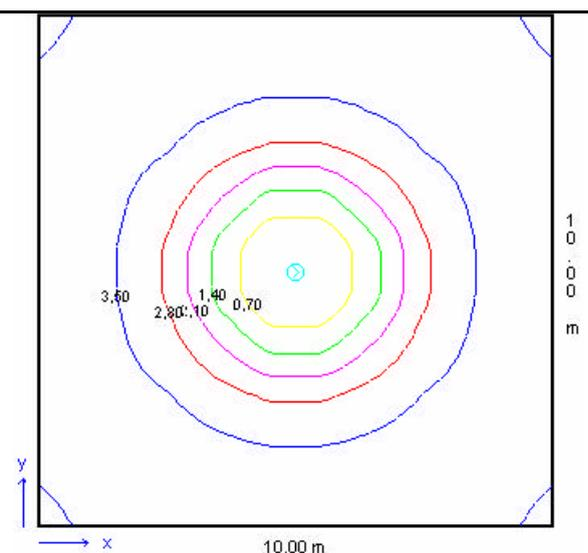
Figura 5.21 – illuminamento con curve isolux rotonde e concentriche.
