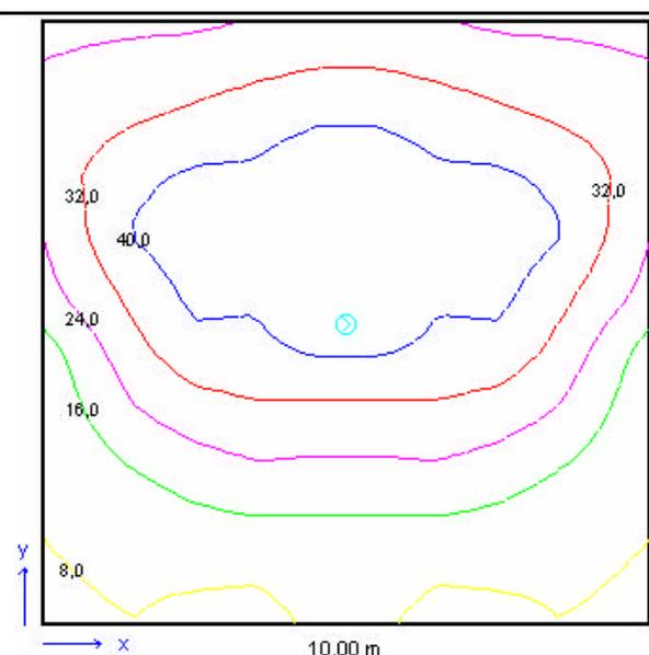
Figura 5.23 – Livelli isolux riferiti all'apparecchio della curva di sinistra.
