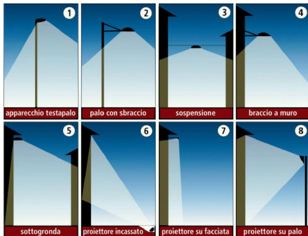
Figura 5.10 – Apparecchi conformi alla LR17/00. Le tipologie 6 e 8 sono ammesse esclusivamente per l’illuminazione di edifici storici a di alto valore architettonico ove non possa essere fatto altrimenti. (fonte Cielobuio)
