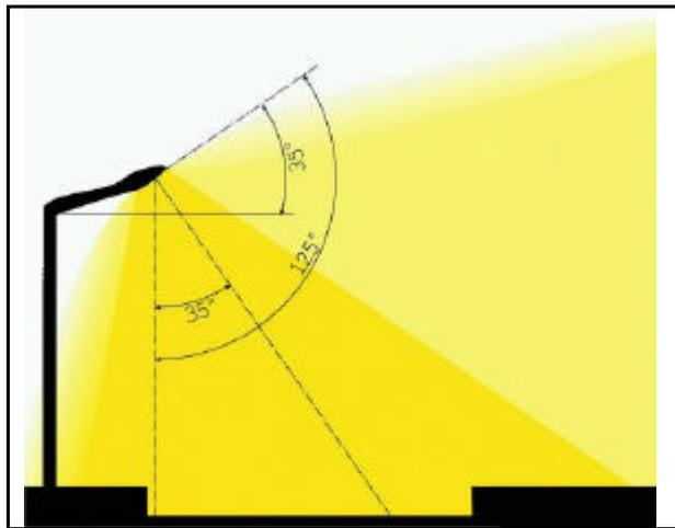
Figura 5.30 Corpo con vetro piano inclinato posto su sostegno inclinato. Installazione scorretta. (fonte Cielobuio)
