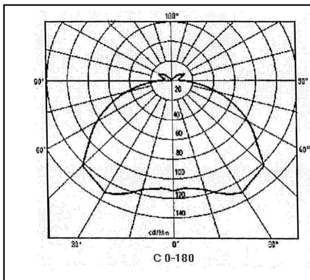
Figura 5.24 – Curva di apparecchio che non allarga il fascio luminoso longitudinalmente alla strada
