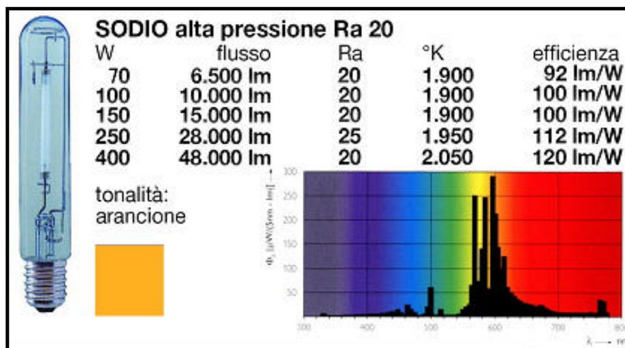
Figura 5.13 – Caratteristiche principali di alcune tipologie di Lampade al sodio alta pressione
