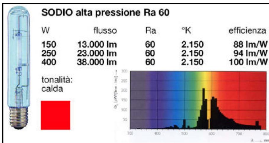
Figura 5.14 – Caratteristiche principali di alcune tipologie di Lampade al sodio alta pressione a Ra maggiorato
