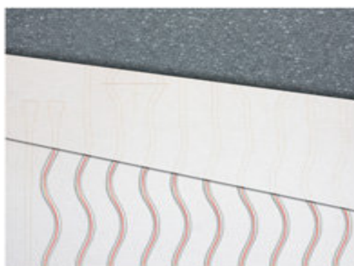
Sistema Leonardo soffitto Lastra isolante in EPS + grafite Passo tubazione MidiX 5,5 cm
